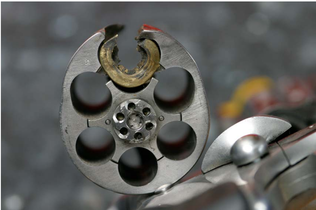
Eine völlig neue Kaliberklasse: .44oval-B, halboffen. Fachleute sind sich einig: Treten solch massive Verformungen des Stoßbodens auf, so muss der Gasdruck nicht nur in einer Druckspitze zu hoch gewesen sein und Materialfehler der Waffe sind auszuschließen.
