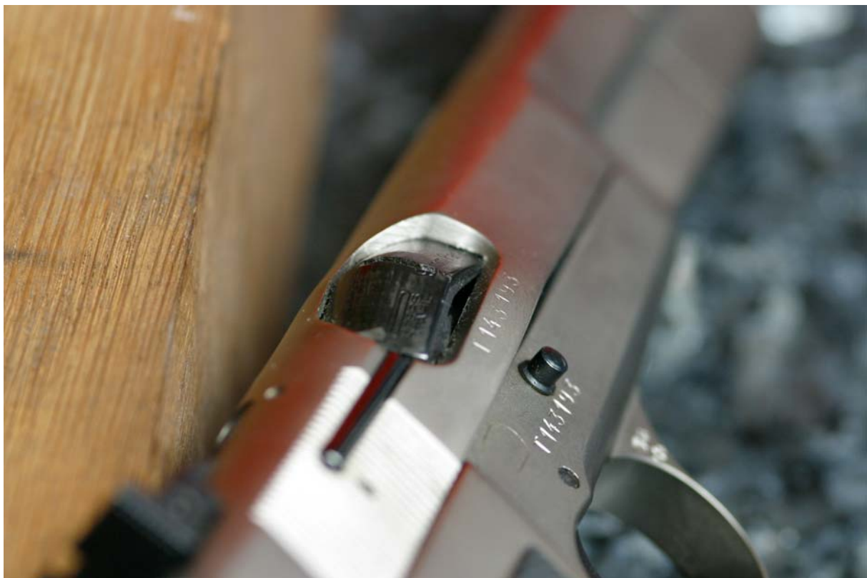
So eine fiese Pocke im Auswurffenster kann einem den Spaß am Schießen ganz schön versauen...
