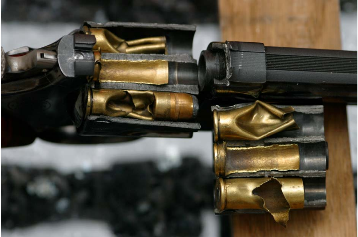
Detailansicht der klassischen Totalzerstörung. Die Proben stammen von diesen beiden Waffen (1, oben und 2, unten)
