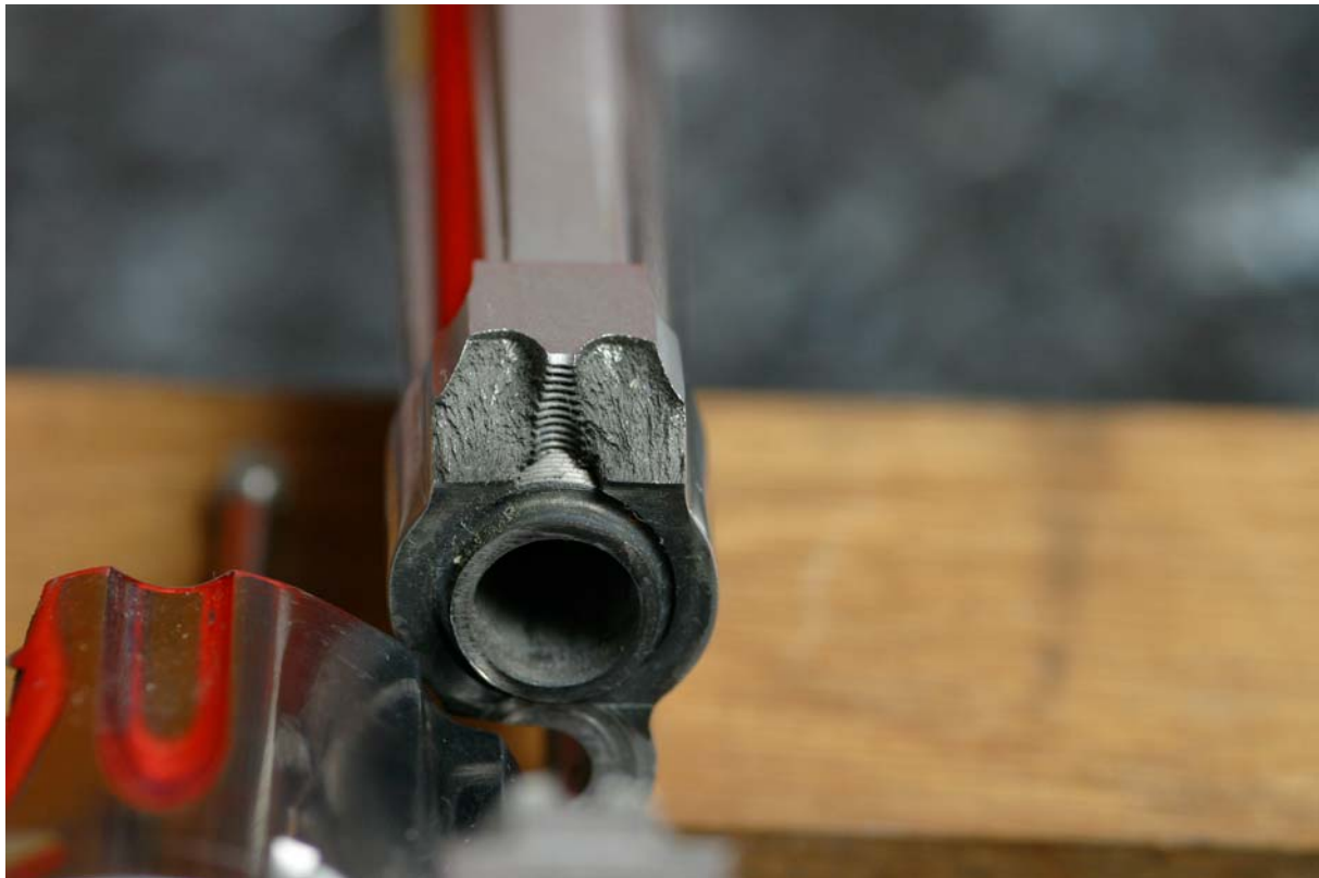
Typisches Abrissmuster der Rahmenbrücke. Nur das Putzen wird so erleichtert...
